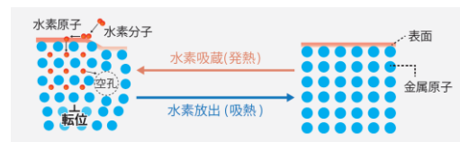
水素吸蔵合金の仕組み [出典 ブラザー工業(株) 資料]
