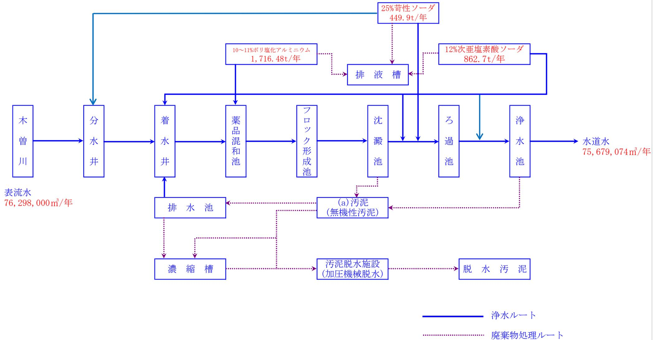
図 2 水道水製造フローシート
