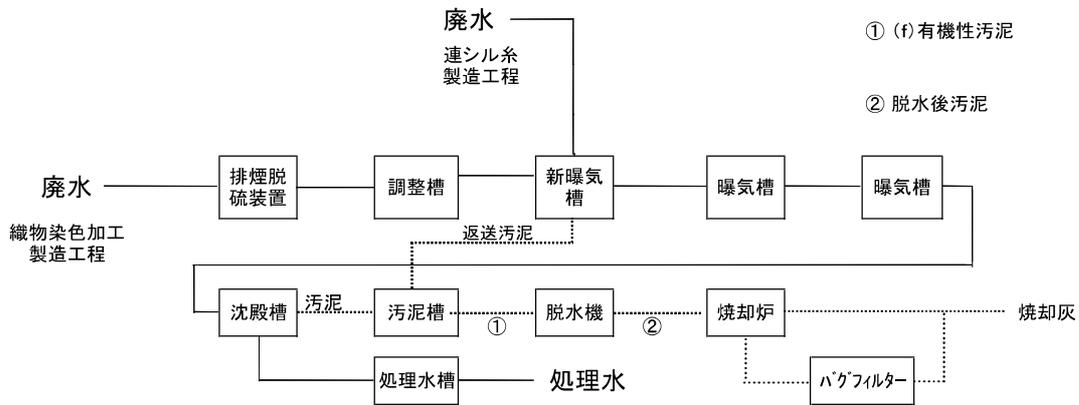
図5 廃水処理工程フローシート
