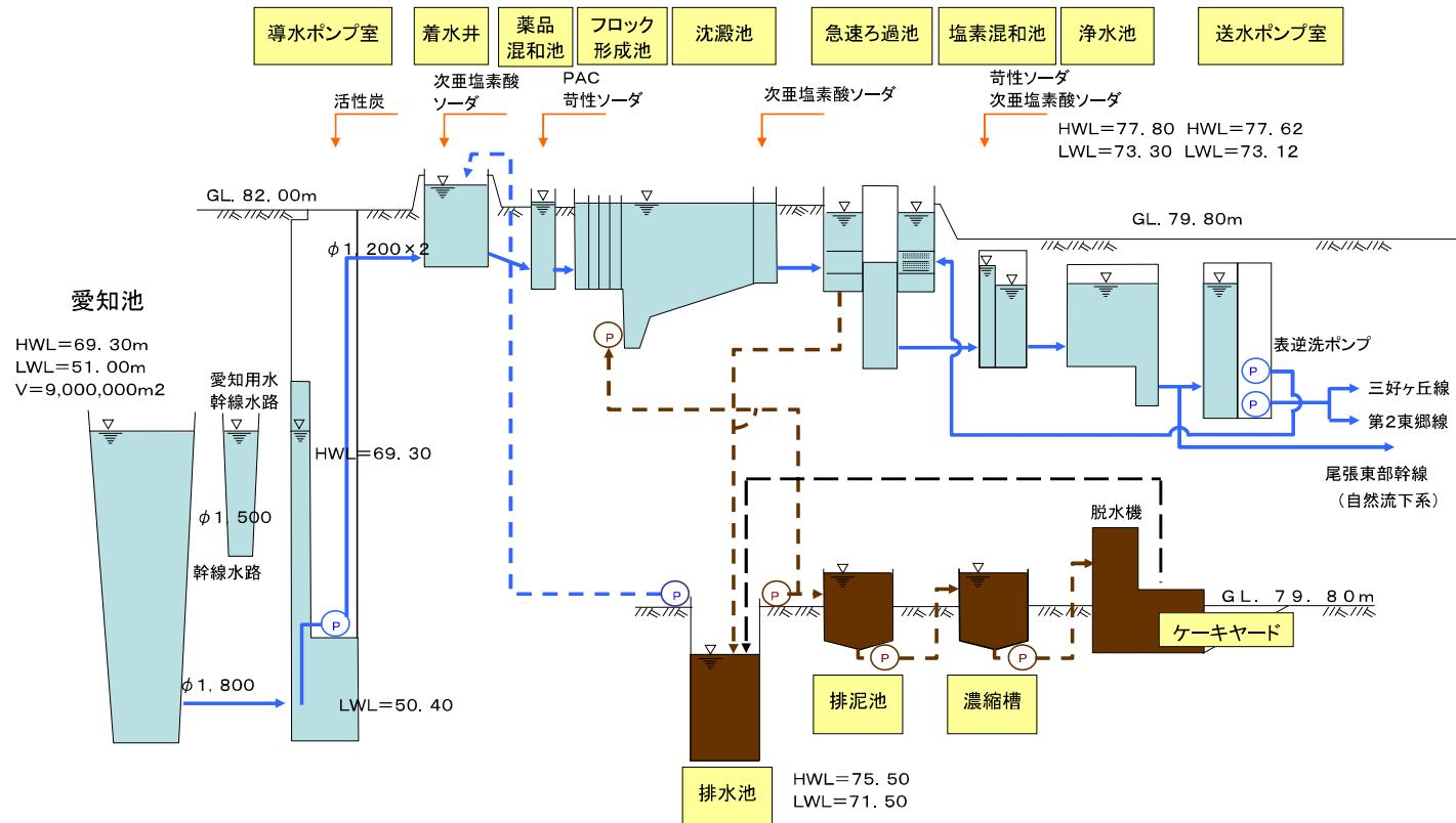
図② 尾張東部浄水場 施設配置図
