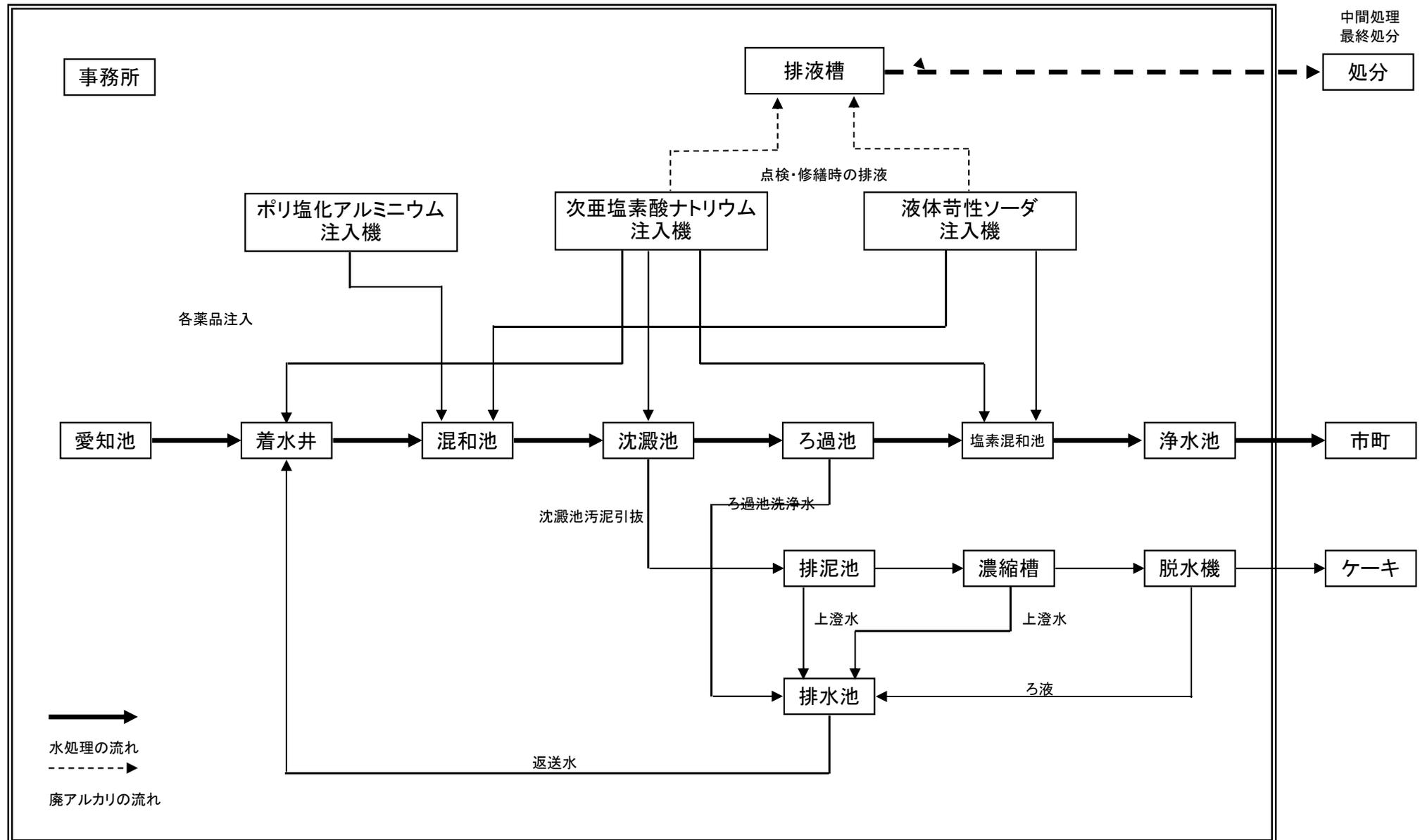
図④ 尾張東部浄水場 汚泥処理のフローシート
