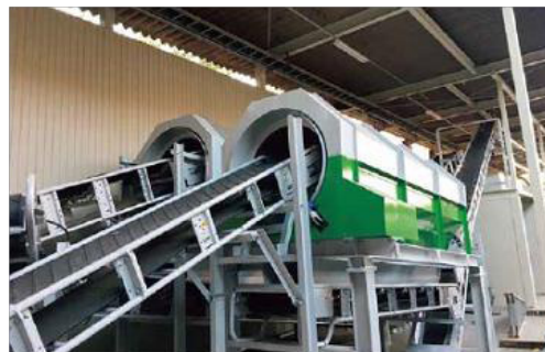
施設整備補助金を活用した 廃プラスチック等の混合廃棄物選別ライン
