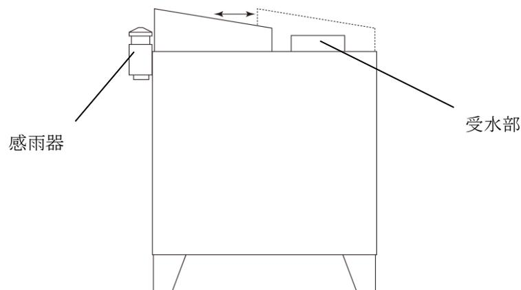
図 6-2 降雨時開放型捕集装置
