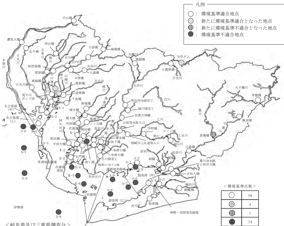
図 5-1-2 河川の BOD 及び湖沼・海域の COD の環境基準適合状況 (2020 年度)
