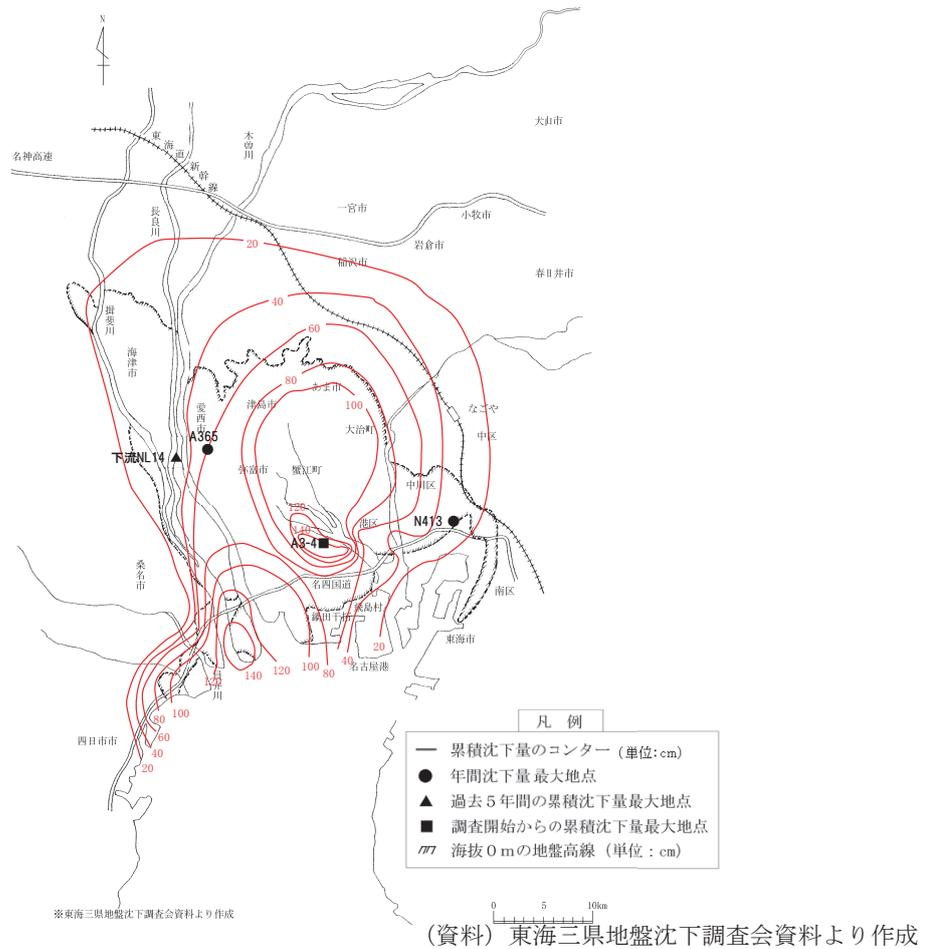
図 7-1-2 西三河地域の累積沈下量及び海拔ゼロメートル地帯の状況
