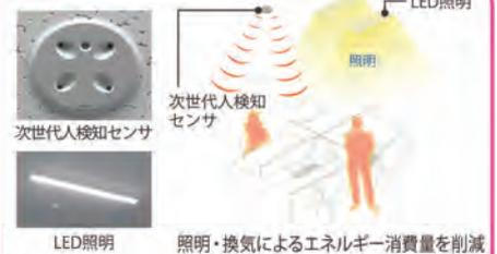
人の在席状況を人の動作でなく、熱でリアルタイムに検知する次世代人検知センサを使って、照明や換気を自動制御。照明器具は、全館にLED照明を採用
