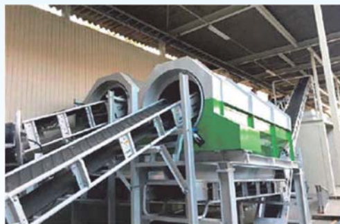
施設整備補助金を活用した 廃プラスチック等の混合廃棄物選別ライン
