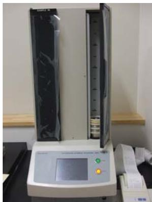
雨水採取器により9時から翌日の9時までの雨水を降雨毎に採取し、そのうちの100mlを直径1インチのステンレス皿に濃縮後、全ベータ線量を計測します。
