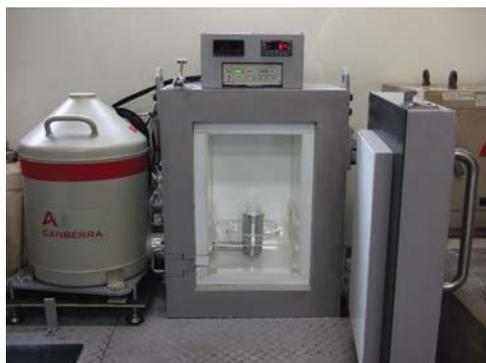
ガンマ線放出核種について核種毎の測定値が得られるため、緊急時の被ばく線量の評価がより正確に把握出来る分析装置です。降水物、土壌、海水など様々な媒体で人工放射性核種の測定をしています。
