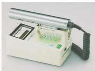
携帯型の放射線測定装置で空間ガンマ線量を測定します。
