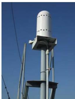
空間ガンマ線量を検出するための装置で、通年連続測定により、私たちが受けている空間ガンマ線量を測定しています。
